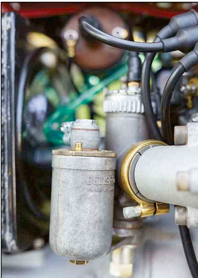
Early V7s used remote float Dell'Orto SS1 carbs.
